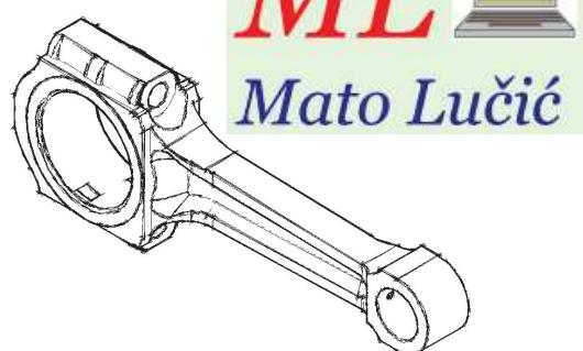
Slika 6. 3D skica klipnjače motora
